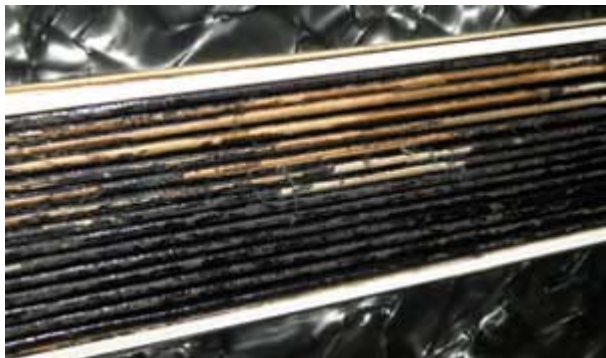
Bälg med stora förslitningsskador
